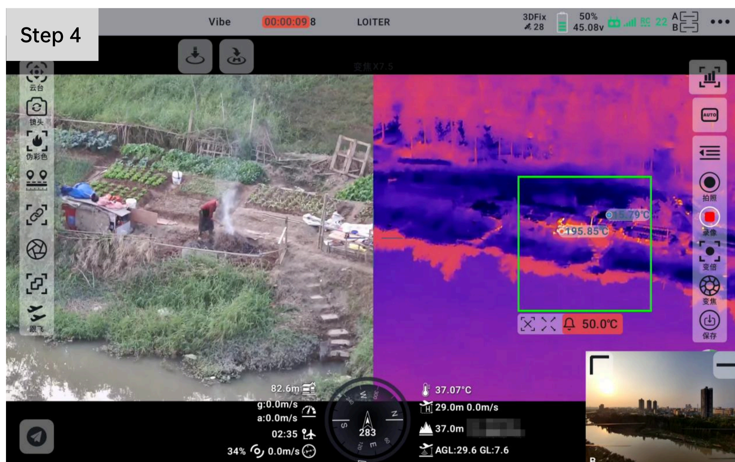
在热成像画面中框选区域进行区域测温，画面将实时显示当前区域内最高、最低温度点。开启全局测温可大范围搜查异常热源，根据需要设置温度报警值，当画面中出高温点，将提示告警。
