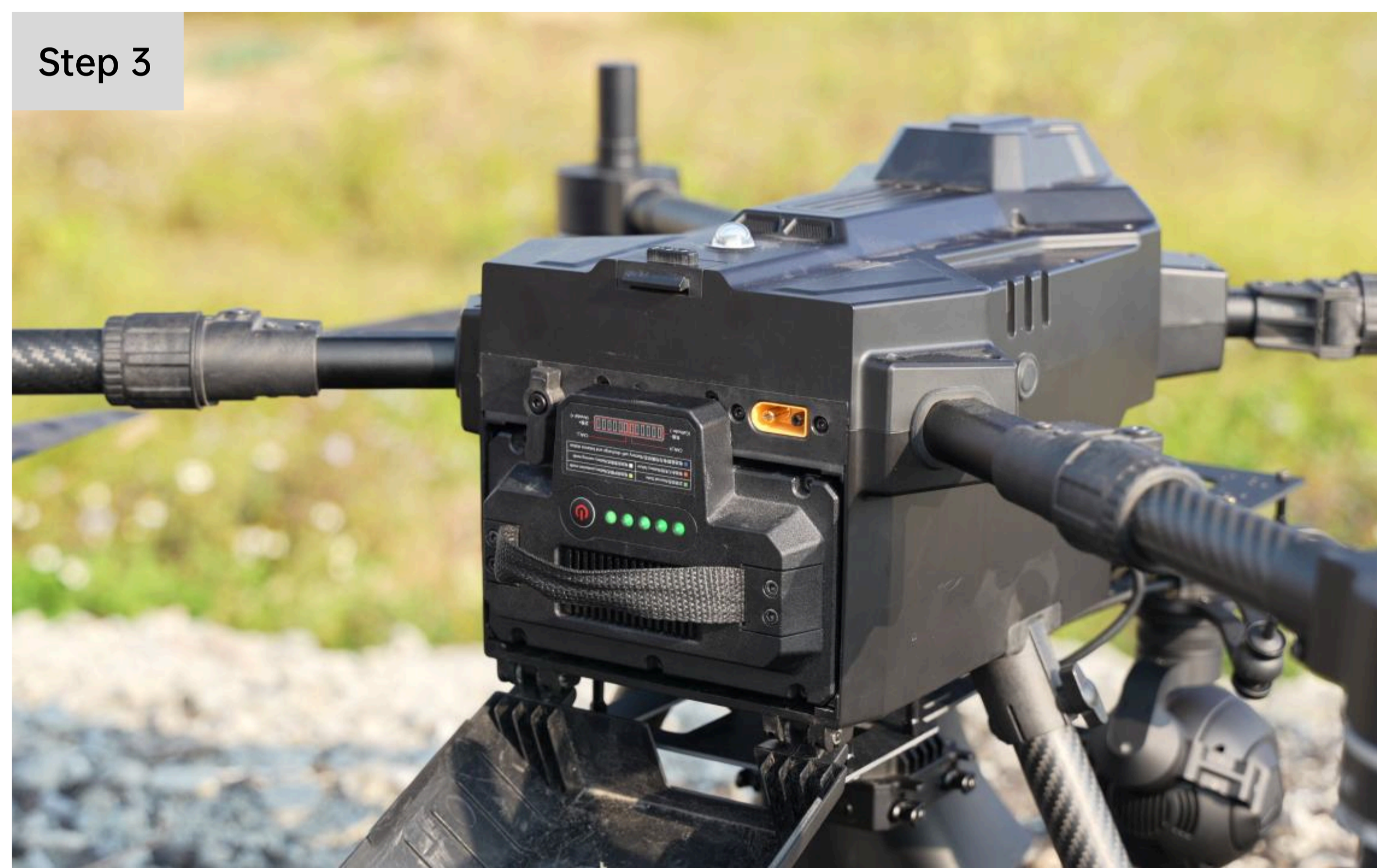
Step 3 安装无人机电池，短按电源键并长按2S开启无人机电源。
