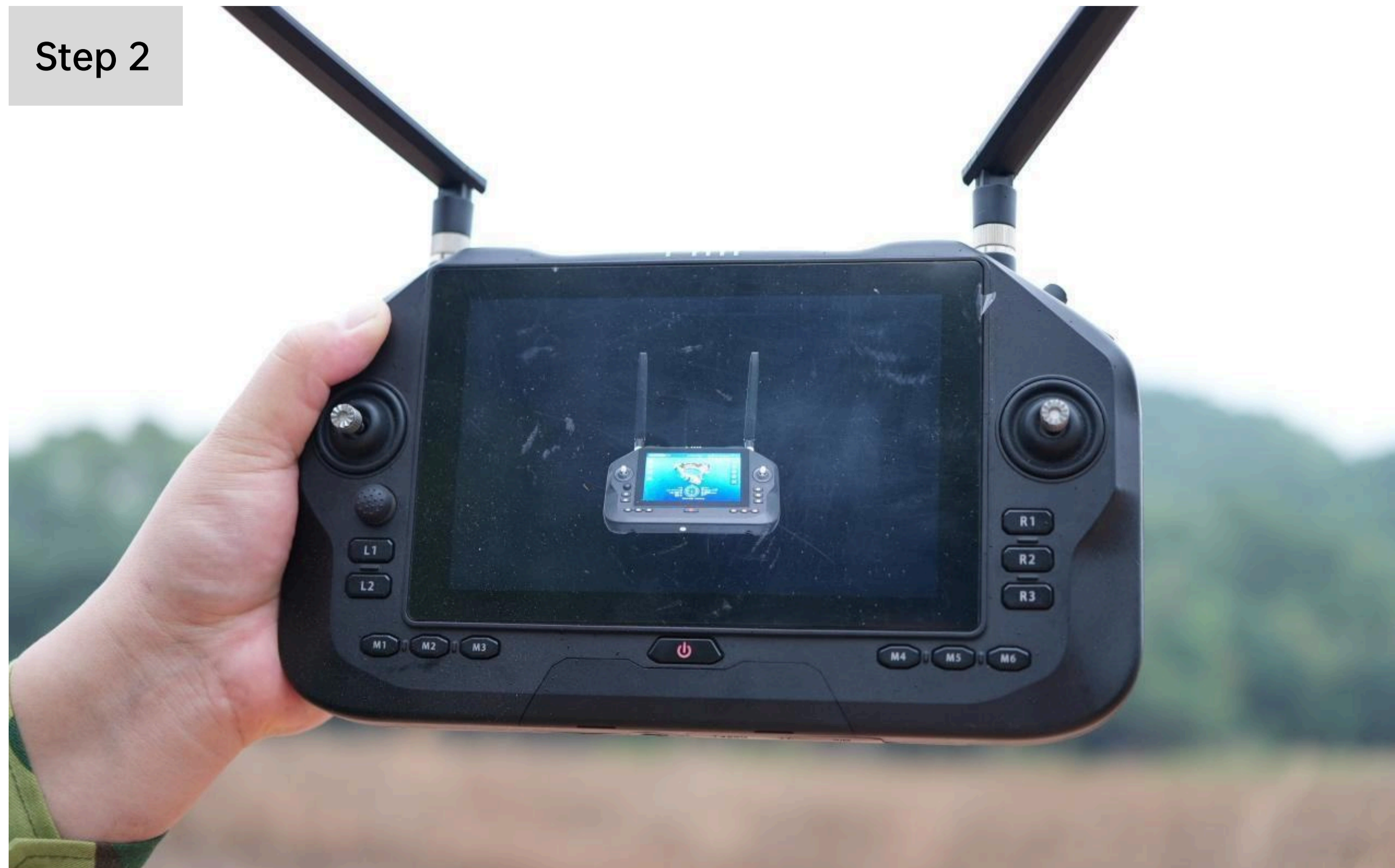
Step 2 取出遥控器，短按电源键并长按2S开启遥控器电源。
