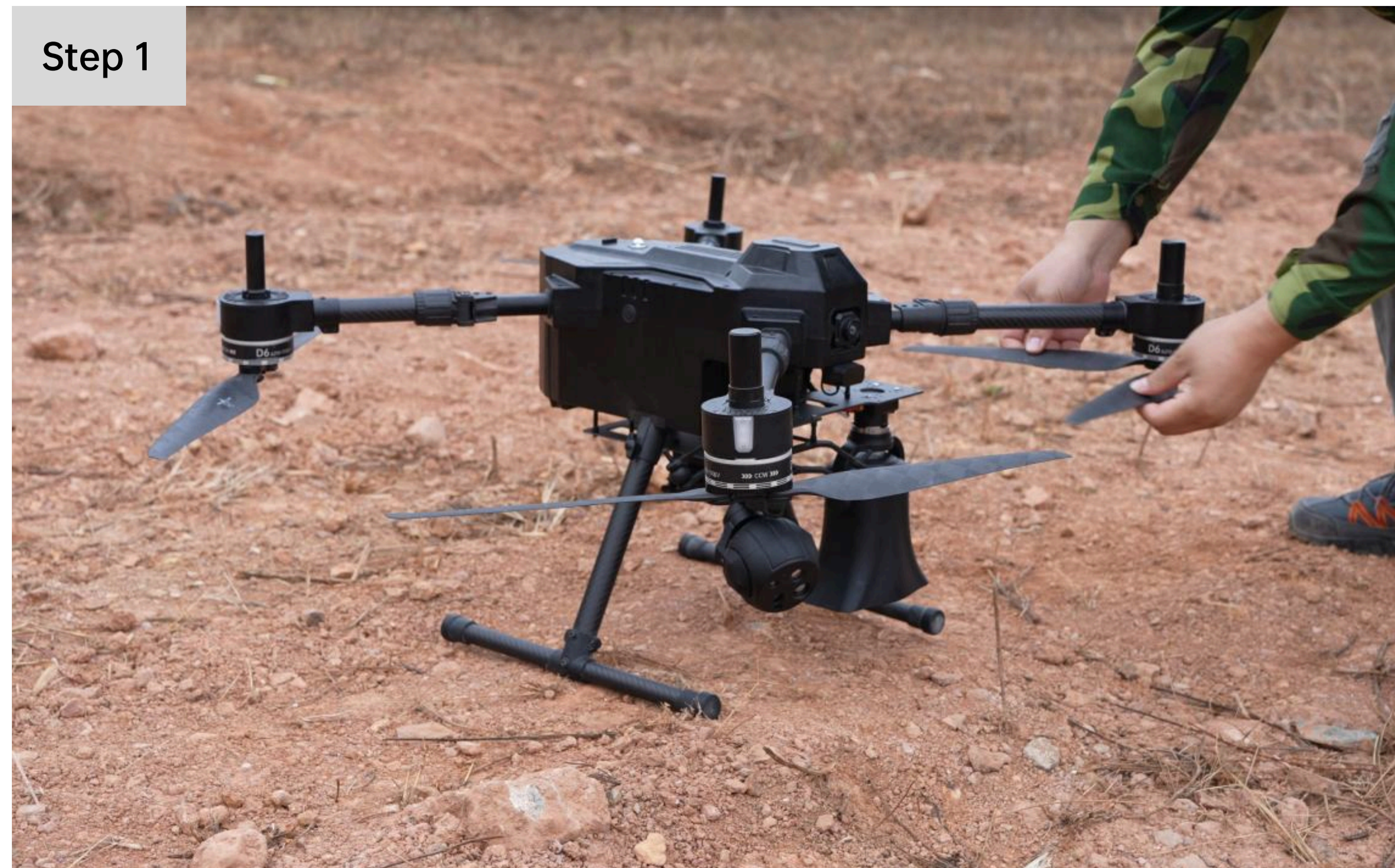
Step 1 到达作业地点，拿出UniDrone E900，打开机臂拧紧机臂套筒并展开无人机桨叶。
