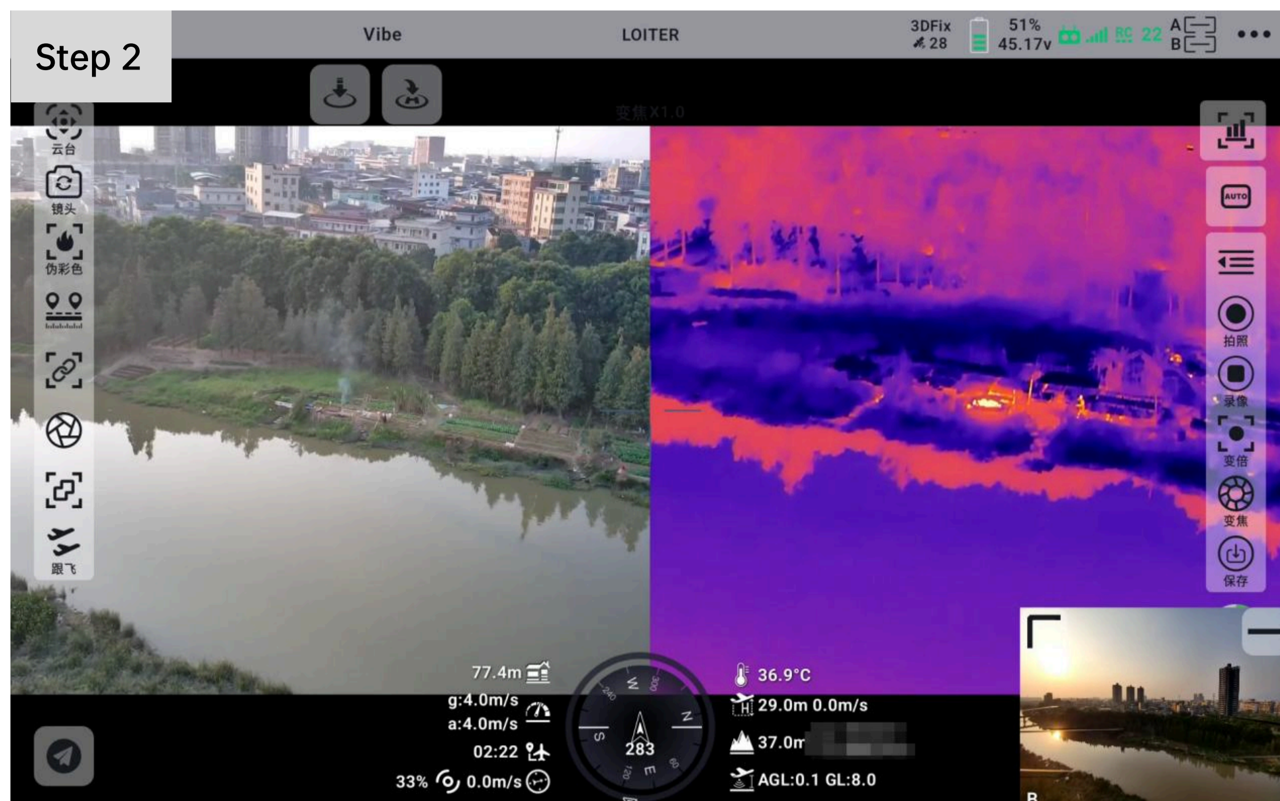
日常巡查时可切换双光联动，可见光画面实时了解异常情况，热成像画面精准锁定异常高温点。
